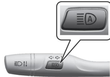
외부 조명 스위치가 AUTO 또는 ◉ 위치에 있을 때, 방향지시등 레버의 ⓂⒶ를 누르면 스마트 하이빔 시스템이 활성화되며 계기판에 녹색 시스템 지시등 ⓂⒶ이 시스템이 활성화 된 것을 알려줍니다.
