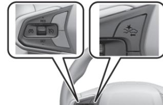
스티어링 휠 상의 을 눌러 전방 충돌 경고 시스템(FCA)의 감도를 원거리, 중거리, 근거리로 설정합니다. 버튼을 한번 누르면 DIC에 현재 설정이 표시됩니다. 이어서 누를 때마다 이 설정이 변경됩니다.
