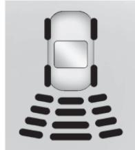
계기판에는 ‘장애물과의 거리’를 보여주는 바가 있으며 주차 보조장치 시스템을 위한 장애물 위치 정보를 보여주는 주차 보조 디스플레이가 있을 수 있습니다. 장애물이 가까워지면 바가 더 많이 빛나며 노란색, 주황색, 적색 순으로 변경될 수 있습니다.
