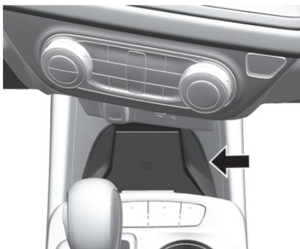
2. 핸드폰을 위쪽을 향하게 놓습니다. 충전 속도를 높이려면 모바일 기기가 제대로 삽입되어 있고 홀더 안에서 가운데에 위치해 있어야 하며 아래에 아무 것도 없어야 합니다. 모바일 기기 케이스가 너무 두꺼우면 무선 충전기가 작동하지 않거나 충전 성능이 저하될 수 있습니다. 자세한 정보는 구입한 대리점에 문의하십시오.
