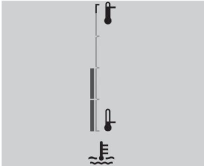
이 온도계는 엔진 냉각수 온도를 나타냅니다. 온도계 지침이 빨간 경고영역 쪽으로 이동하는 경우, 엔진이 과열된 것입니다. 엔진 냉각수가 과열된 경우, 차량을 도로 밖으로 주행하여 정차한 다음 엔진을 즉시 끕니다. 냉각수 양과 냉각수 누수 여부를 확인한 후 당사 정비망에서 점검을 받으시기 바랍니다.
