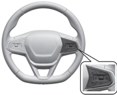
스티어링 휠 버튼을 이용해 주행 정보 표시창(DIC), 일부 운전자 보조 시스템, 인포테인먼트 시스템 및 연결된 핸드폰을 조작할 수 있습니다.
