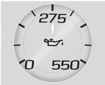
엔진 오일 압력 게이지에는 엔진이 작동할 때 kPa(킬로파스칼) 단위로 엔진 오일 압력을 표시합니다.
