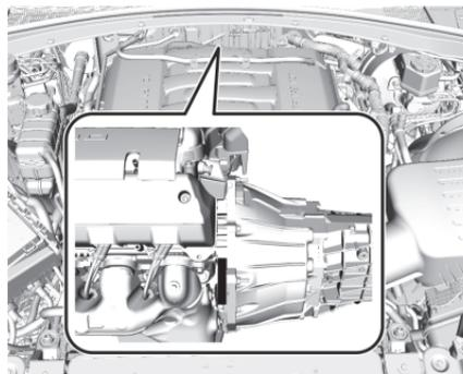
엔진 형식 및 엔진 번호는 차량 앞쪽에서 엔진룸을 바라볼 때 실린더 블록 트랜스미션 접합부에 타각되어 있습니다.
