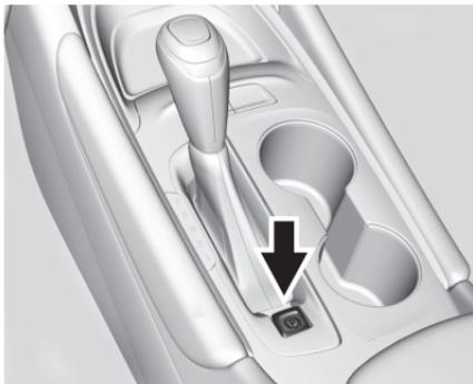
전자식 주차 브레이크 (Electric Parking Brake, EPB) 스위치는 변속기 아래쪽에 있습니다. EPB는 시동이 꺼진 상태에서도 항상 작동할 수 있습니다. 배터리 방전을 방지하기 위해, 엔진이 가동되지 않는 상태에서는 EPB를 반복 사용하지 마십시오. 배터리 충전 상태가 충분치 않을 경우 EPB를 체결 하거나 해제할 수 없습니다.
