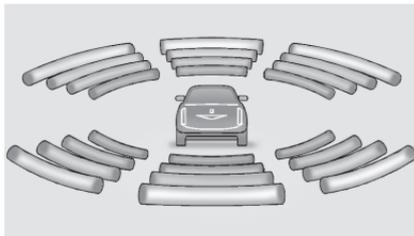
계기판에는 "장애물과의 거리"를 보여주는 바가 있으며 주차 보조장치 시스템을 위한 장애물 위치 정보를 보여주는 주차 보조 디스플레이가 있을 수 있습니다. 장애물이 가까워지면 바가 더 많이 빛나며 노란색, 주황색, 적색 순으로 변경될 수 있습니다.
