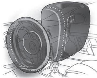
전방 에어백 시스템은 앞좌석 탑승자가 앞으로 못 움직이게 함으로써 상체 및 머리에 대한 부상 위험을 현저하게 감소시킵니다.
