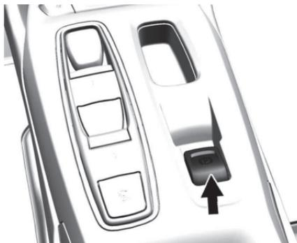
전자식 주차 브레이크 (Electric Parking Brake, EPB) 스위치는 센터 콘솔에 있습니다. EPB는 시동이 꺼진 상태에서도 항상 작동할 수 있습니다. 배터리를 방전을 방지하기 위해, 시동이 꺼진 상태에서는 EPB를 반복 사용하지 마십시오.
