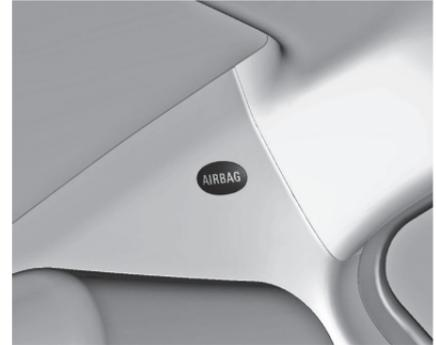
커튼 에어백 시스템은 각 측면의 루프 프레임 안에 있는 한 개의 에어백으로 구성되어 있습니다. 이는 루프 필라에 AIRBAG 이란 글자로 표시되어 있습니다.
