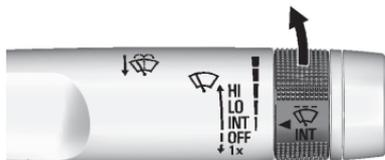
**↑** : 앞유리 와셔액을 분사하고 와이퍼를 작동하려면 앞유리 와이퍼 레버를 운전자 쪽으로 잡아당기십시오. 레버를 놓을 때까지, 또는 최대 세척 시간에 도달할 때까지 와이퍼가 계속 작동합니다. 앞유리 와이퍼 레버를 놓을 때, 앞유리 와셔가 작동한 시간에 따라 와이퍼가 몇 번 더 작동될 수 있습니다.
