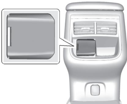
전원 소켓은 중앙 콘솔 뒤에 있습니다. 전원 소켓의 표시등이 켜져서 사용중임을 나타냅니다. 시동 버튼이 ON에 있을 때 150W 미만이 필요한 전기 기기를 소켓에 꽂고 시스템 고장이 없으면 표시등이 켜집니다.
