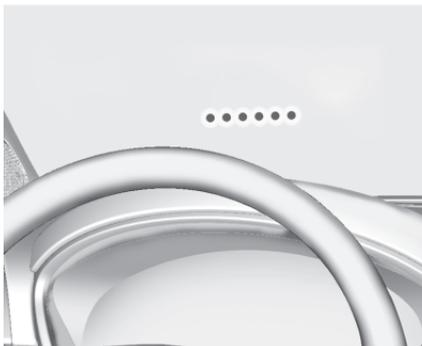
헤드업 LED 경고등(Reflected LED Alert Display, RLAD)은 차량이 선행 차량에 너무 빠르게 접근하는 경우 작동하며, 앞유리에 6개의 적색등이 반사되어 점멸하고 경고음이 울려 충돌 경고를 합니다.
