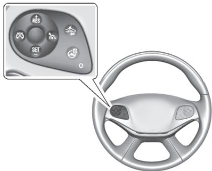
스티어링 휠 상의 충돌 경고 버튼
