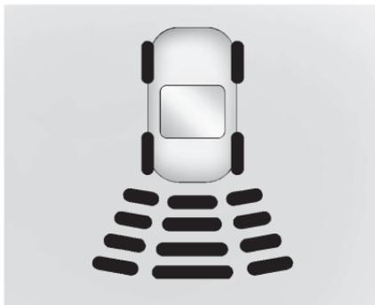
계기판에는 RPA를 위한 물체까지의 거리 및 물체 위치 정보를 보여주는 막대들을 포함한 주차 보조장치 디스플레이가 있습니다. 물체가 가까워질수록, 더 많은 막대가 점등되고 막대의 색상은 노란색에서 주황색 내지 빨간색으로 변합니다.
