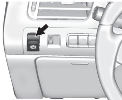
전자식 주차 브레이크 (Electric Parking Brake, EPB) 스위치는 인스트루먼트 패널의 좌측에 있습니다. EPB는 시동이 꺼진 상태에서도 항상 작동할 수 있습니다. 배터리 방전을 방지하기 위해, 엔진이 가동되지 않는 상태에서는 EPB를 반복 사용하지 마십시오.
