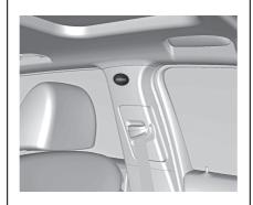
커튼 에어백 시스템은 각 측면의 루프 프레임 안에 있는 한 개의 에어백으로 구성되어 있습니다. 이는 AIRBAG 이란 글자로 표시되어 있습니다.
