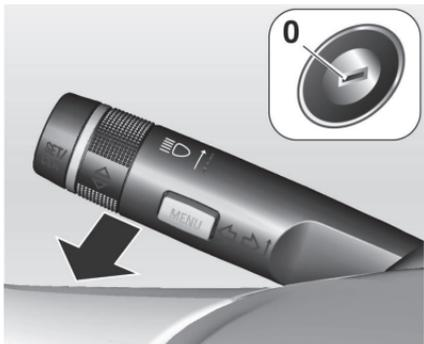
아래의 설정 절차는 자동 라이트 기능이 없는 차량에만 적용되며 라이트 스위치 모드가 **OFF**여야 합니다. 운전석 도어를 닫으면 설정 시간동안 작동한 후 자동으로 꺼지게 됩니다.
