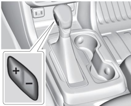
레인지 선택 모드는 내리막길을 주행할 때 또는 트레일러를 견인할 때 원하는 기어 레인지를 선택하게 하여 차량 변속기 및 차량 속도를 조절하도록 합니다.
