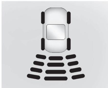
계기판에는 "물체까지의 거리" 및 물체 위치 정보를 보여주는 막대들을 포함한 주차 보조장치 디스플레이가 있습니다. 물체가 가까워질수록, 더 많은 막대가 점등되고 막대의 색상은 노란색에서 주황색 내지 빨간색으로 변합니다.
