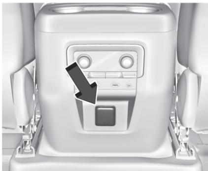
시동버튼이 ON에 있을 때, 버튼이 눌러진 이후 220볼트 소켓으로의 전원 공급이 활성화됩니다. 버튼 상의 녹색 지시등은 220V 소켓이 활성화된 때를 나타냅니다. 220V 전원은, 자체가 활성화되고 전기 기기의 플러그가 그 소켓에 끼워질 때, 소켓으로 공급됩니다. 하나의 전원 소켓은 최대 400W를 사용하는 전기 기기를 위해 사용될 수 있습니다. 모든 연결된 장치는 400W를 초과하지 않도록 하십시오.
