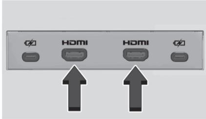
HDMI 입력단에는, HDMI A/V 케이블을 이용하여, 캠코더, 비디오 게임 시스템 또는 Apple 기기와 같은 보조장치를 연결할 수 있습니다. Apple 기기를 위해 Apple 사의 케이블이 요구됩니다.
