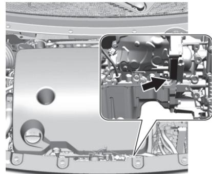
엔진 형식 및 엔진 번호는 차량 앞쪽에서 엔진룸을 바라볼 때 실린더 블록 우측 전면부에 타각되어 있습니다.
