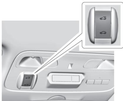
선루프는 점화 스위치가 ON/RUN(켜짐/주행)이나 ACC/ACCESSORY(액세서리) 위치에 있거나, 또는 유보 액세서리 전원(RAP)이 활성화되어 있을 때만 작동합니다. 유보 액세서리 전원(RAP)을 참조하십시오.
