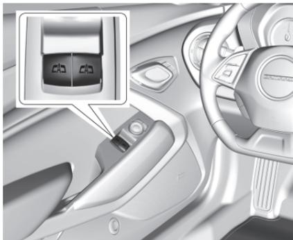
윈도우는, 차량 점화 스위치가 **ON/RUN, ACC/ACCESSORY** 위치에 있거나, 또는 유보 액세스리 전원(**RAP**) 이 활성 상태에 있을 때 작동합니다. 유보 액세스리 전원(**RAP**)을 참조하십시오.
