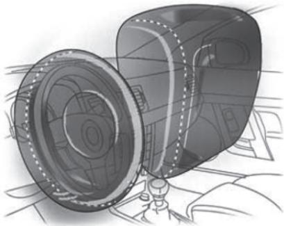
전방 에어백 시스템은 앞좌석 탑승자가 앞쪽으로 못 움직이게 함으로써 상체 및 머리에 대한 부상 위험을 현저하게 감소시킵니다.
