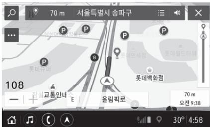
주유소와 주차장과 같은 스마트 POI 아이콘은 시간, 위치, 주행 조건 및 차량 상태에 따라 표시됩니다.
