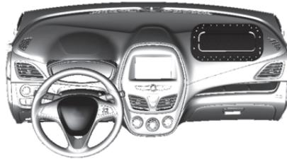
전방 에어백 시스템은 스티어링 휠 내부에 있는 한 개의 에어백 및 조수석 인스트루먼트 판넬 내부에 있는 한 개의 에어백으로 구성되어 있습니다.
