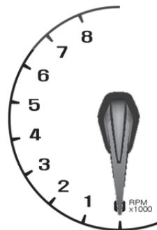
1분당 엔진 회전수(rpm)를 나타냅니다. 적절한 변속시기를 선택하는데 사용하고 엔진의 과회전 또는 과부하를 방지하십시오.
