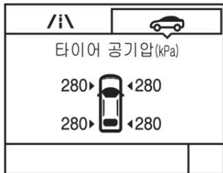
타이어 또는 타이어 공기압 센서 교환 시, 타이어 공기압 모니터링 시스템의 센서 일치 절차를 진행할 수 있습니다.
