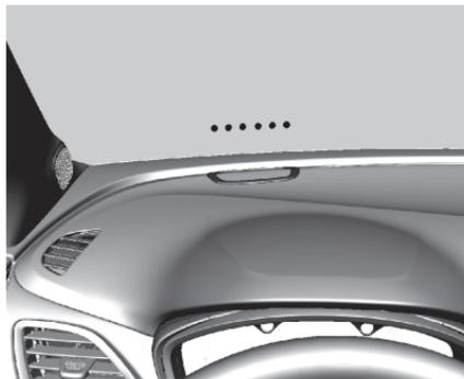
전방 충돌 경고 발생 시에는 붉은 색 LED가 운전석 앞유리에 반사되어 표시됨(RLAD)과 동시에 경고음이 동반됩니다. 안전에 주의하십시오.
