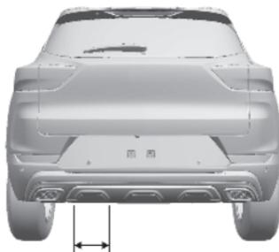
작동시키려면, 후방 범퍼 좌측 아래의 프로젝션 로고 위치에 전방으로 발로 차는 동작을 합니다. 차는 동작 영역이 후방 범퍼의 14 cm 이내에 와야 작동합니다.
