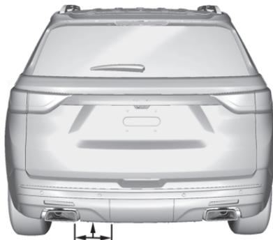
작동시키려면, 후방 범퍼 좌측 아래의 프로젝션 로고 위치에 전방으로 발로 차는 동작을 합니다. 차는 동작 영역이 후방 범퍼의 14cm 이내에 와야 작동합니다.
