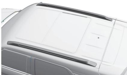
주행 시 화물 손상 또는 분실 방지를 위해 가로대 및 화물이 견고하게 조여졌는지 점검합니다. 루프랙에 화물을 적재하면 차량의 무게 중심이 더욱 높아지게 됩니다. 고속, 급출발, 급회전, 급제동 또는 급조작은 피하십시오. 그렇지 않으면 통제력을 잃을 수도 있습니다. 장거리, 울퉁불퉁한 도로 또는 고속에서 주행 중 수시로 차량을 정지시켜 화물이 그대로 놓여 있는지 확인하십시오. 차량 적재 시 최대 차량용량을 초과하면 안됩니다.
