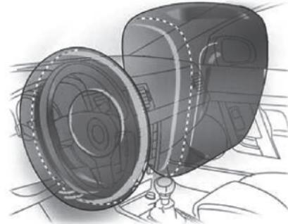
전방 에어백 시스템은 앞좌석 탑승자가 앞쪽으로 놓 움직이게 함으로써 상체 및 머리에 대한 부상 위험을 현저하게 감소시킵니다.
