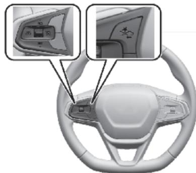
스티어링 휠 상의
