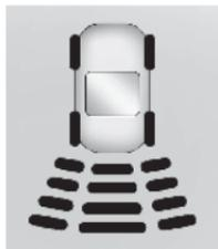
계기판에는 ‘장애물과의 거리’를 보여주는 바가 있으며 주차 보조장치 시스템을 위한 장애물 위치 정보를 보여주는 주차 보조 디스플레이가 있을 수 있습니다. 장애물이 가까워지면 바가 더 많이 빛나며 노란색, 주황색, 적색 순으로 변경될 수 있습니다.
