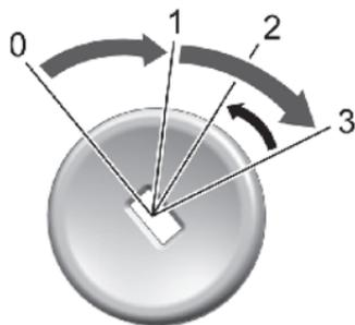
1. 위치 1로 키를 돌리십시오. 스티어링 휠 잠금을 해제하기 위해서 스티어링 휠을 살짝 움직이십시오. 자동 변속기의 변속 레버를 P 위치로 옮기십시오. 가속하지 마십시오.
