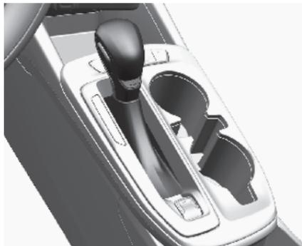
전자식 주차 브레이크 (Electric Parking Brake, EPB) 스위치는 센터 콘솔에 있습니다. EPB는 시동이 꺼진 상태에서도 항상 작동할 수 있습니다. 배터리 방전을 방지하기 위해, 엔진이 가동되지 않는 상태에서는 EPB를 반복 사용하지 마십시오.
