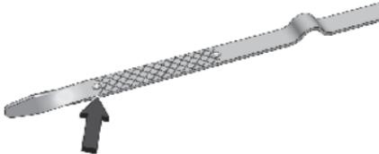
엔진 오일 레벨은 최소 표시와 최대 표시 사이로 유지하고, 격자 표시 아래 영역인 화살표 지점 이하로 떨어질 경우 당사 권장 오일 1L를 보충한 후 레벨을 다시 확인하여 오일 레벨을 적정 수준으로 유지하십시오.
