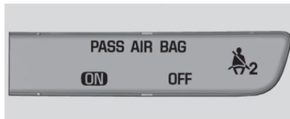
승객 감지 시스템은 특정 상황 하에서 앞좌석 조수석 전방 에어백과 무릎 에어백의 작동을 해제합니다. 다른 어떤 에어백도 승객 감지 시스템의 영향을 받지 않습니다.
