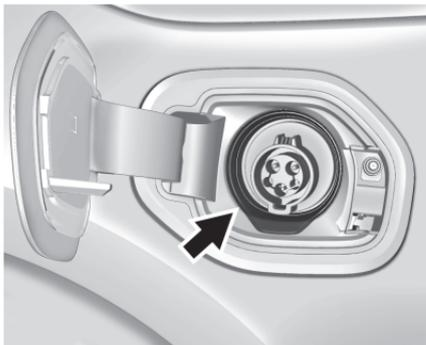
충전 코드를 콘센트에 꽂아 충전할 때 충전 포트 베젤 등 (장착된 경우)은 보조 CSI 역할을 합니다. 계기판의 CSI와 함께 감박입니다. 충전 포트 도어가 열려있고 아직 차량이 연결되지 않았을 경우, 베젤등이 켜져 충전 소켓을 비춰줍니다.
