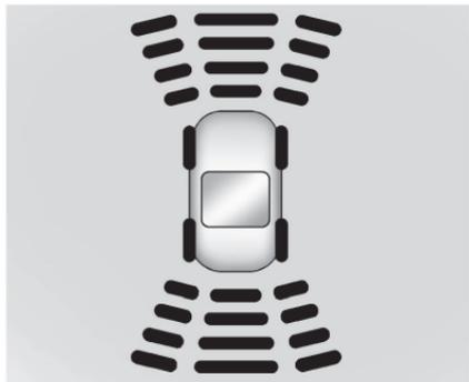
계기판에는 RPA(일부 차량의 경우 FPA)를 위한 "물체까지의 거리" 및 물체 위치 정보를 보여주는 막대들을 포함한 주차 보조장치 디스플레이가 있습니다. 물체가 가까워질수록, 더 많은 막대가 점등되고 막대의 색상은 노란색에서 주황색 내지 빨간색으로 변합니다.
