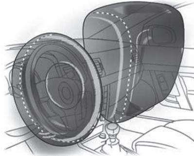
전방 에어백 시스템은 앞좌석 탑승자가 앞쪽으로 못 움직이게 함으로써 상체 및 머리에 대한 부상 위험을 현저하게 감소시킵니다.
