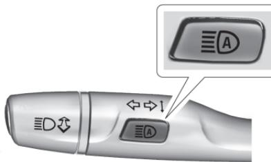
외부 조명 스위치가 **AUTO** 또는 **D** 위치에 있을 때, 방향지시등 레버의 **☰(A)**를 누르면 스마트 하이빔 시스템이 활성화되며 계기판에 녹색 시스템 지시등 **☰(A)**이 시스템이 활성화 된 것을 알려줍니다.
